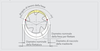
Il diametro della fresa per filettare e la profondità del profilo determinano l'angolo di lavoro rispetto al diametro della filettatura.
