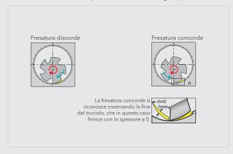
Se possibile, per la fresatura di filetti si consiglia una fresatura discorde, al fine di ottenere forze di taglio ridotte, una migliore formazione del truciolo, una maggiore durata e ottime qualità di superficie.
