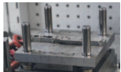
Gestelle und Säulen sind ein typischer Fall für den Normalienlieferanten. Die Fertigungskapazitäten beim Werkzeugbauer sind dafür zu wertvoll.
